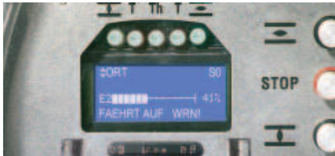
In der Standardanzeige wird angezeigt, dass eine Warnung (WRN) vorhanden ist. Der Antrieb fährt weiter.
