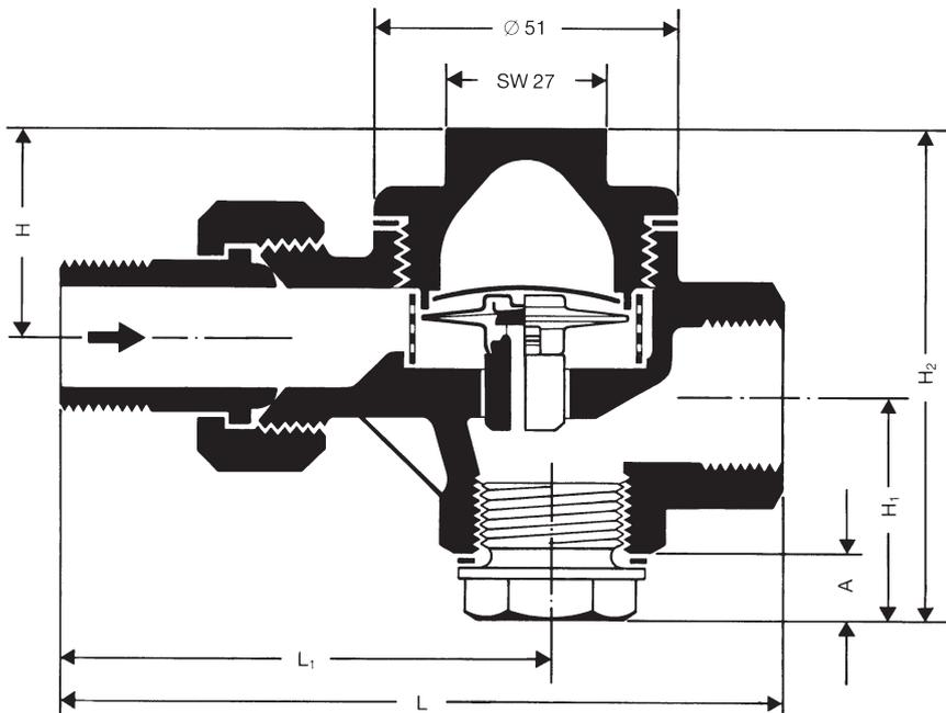
Thermischer Kondensatableiter, besonders geeignet für Dampfheizungen und andere Niederdruckdampfanlagen. Das Öffnen und Schließen wird durch die Mono-Regelmembran abhängig von der Temperatur und vom Druck im Ableitergehäuse gesteuert.
